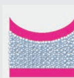
Constellation des billes MicroSpace Vacuform® 2.0 lorsque le matelas est en dépression
