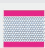
Constellation des billes MicroSpace Vacuform® 2.0 lorsque le matelas est soumis à la pression ambiante
